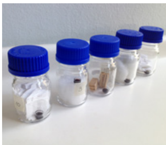
Figura 3. Análisis de ácido cromotrópico para la caracterización de formaldehído (Fotografía: Araya, C. 2015).
