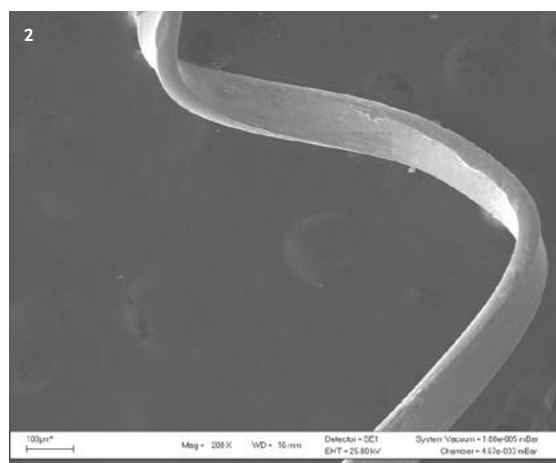
Figura 2. Imagen obtenida con microscopía electrónica de barrido (SEM/EDS), con una magnificación de 300X, identificando las técnicas de lámina batida cortada (1) y alambre grueso trefilado y laminado (2) (Fotografía: Laboratorio de SEM/EDS de la Pontificia Universidad Católica de Chile, 2012).
