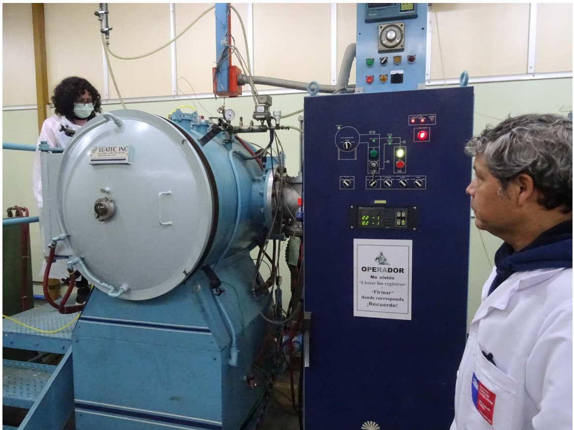
Figura 3. Vista general de la cámara multipropósito. Se observa a la izquierda la cámara y a la derecha el panel de control para el sistema de vacío e ingreso de gases (Fotografía: Dinator, M. 2023).
